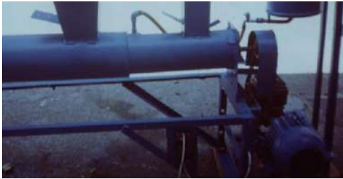
Şək.2.15. Eksperimental yem qarışdırıcısının əsas işçi orqanının intiqal mexanizmi.
