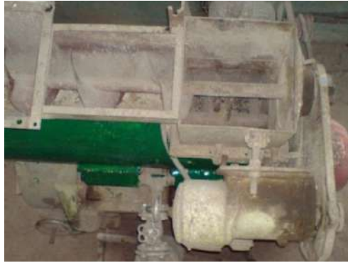
Şək.4.15. Eksperimental kondisiyalaşdırıcının qurğunun üzərində quraşdırılması.
