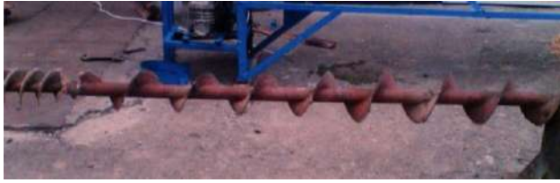
Şək.2.12. Çıxışa doğru dolaq diametri artan şnek.
